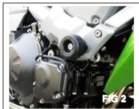
Avvitare direttamente il paratelaio utilizzando la vite lunga 80mm e relativo distanziale alto 22mm.
