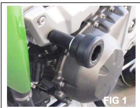
Avvitare direttamente il paratelaio utilizzando la vite 110mm e relativo distanziale 39mm.
