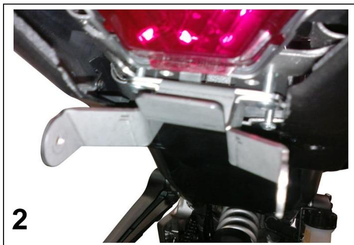
Montare il supporto VMC con le 4 viti in dotazione (Fig.2)
