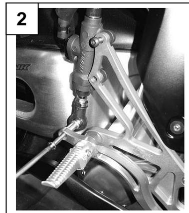
Completare l'assemblaggio della pompa.
